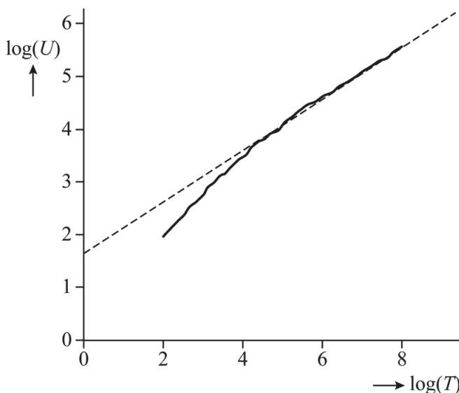
De grafiek in figuur 2 geeft het werkelijke verband tussen  $U$  en  $T$  in RCV1 en de gestippelde lijn geeft een benadering volgens de wet van Herdan-Heap.
